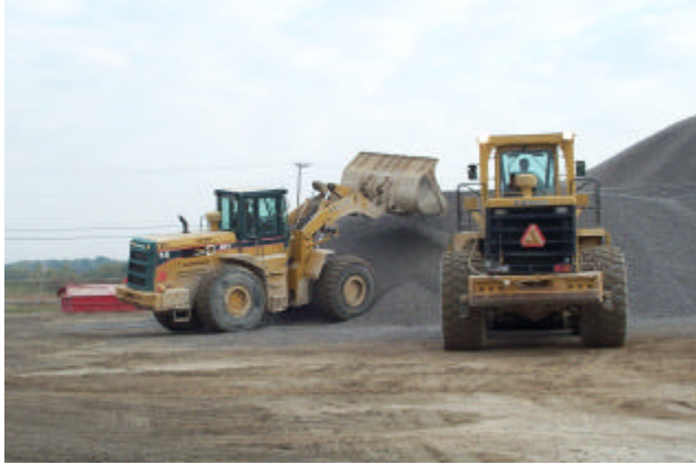
Figura 6.2 – Trabajando en el acopio de agregados
