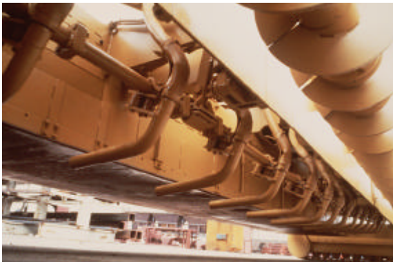
Figura 8.5 –Distribución y posición de los vibradores
