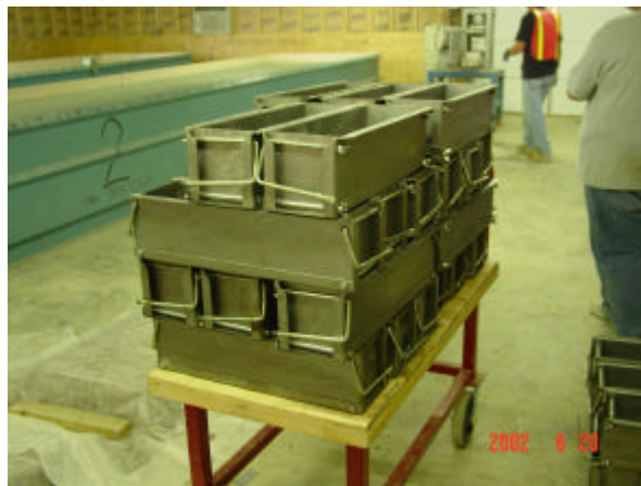
Figura 10.2 – Laboratorio en obra para fabricación y curado de vigas
