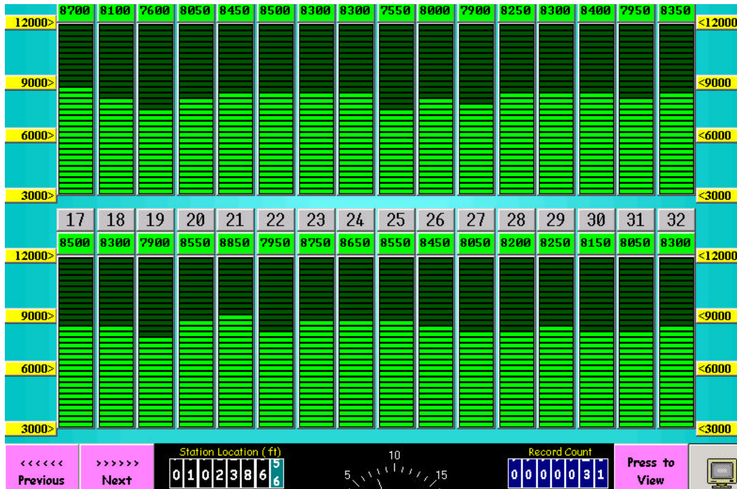
Figura 8.7 – Pantalla de un sistema de vibrado inteligente mostrando la frecuencia de cada vibrador
